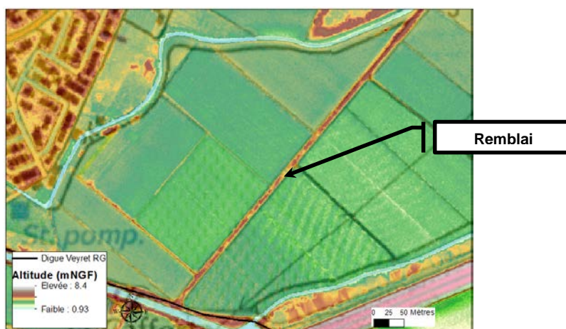
Figure 49 : Remblai de la voie d'accès au pont de la route de Montfort
