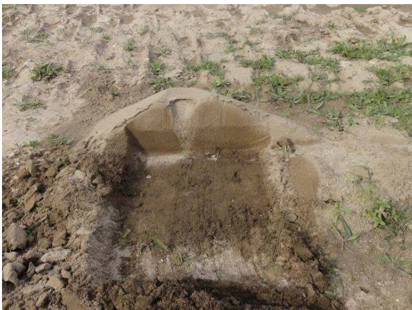
Figure 62 : Coupe d'un sand Boil derrière les digues de l'Agly - crue du 6 mars 2013 - (photo : DDT des Pyrénées-Orientales)
