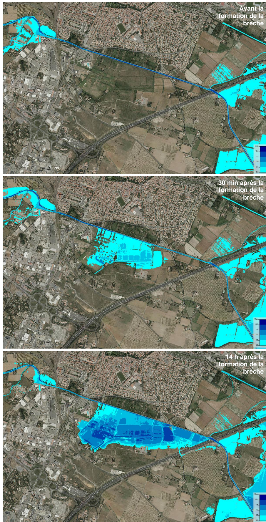
Figure 49 : Cinétique d'une éventuelle rupture en rive droite du couloir endigué [Q30 en état aménagé]
