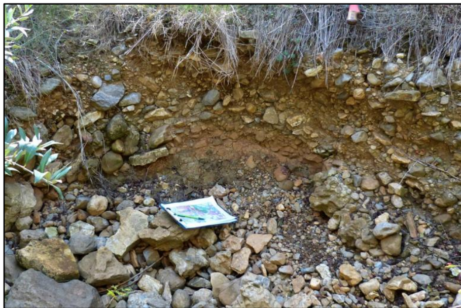
Photo 4 : Alluvions argilo-caillouteuse dans le talweg au droit du projet Puissance totale des alluvions 1,0 à 1,50 m
