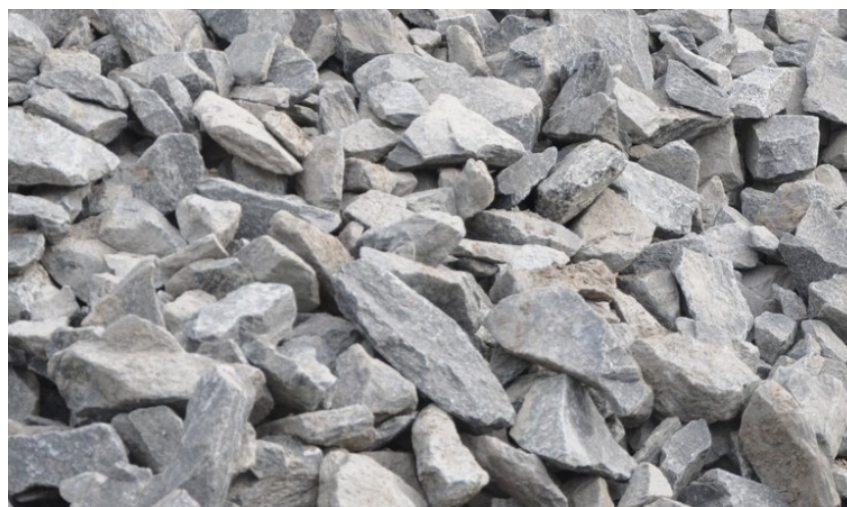
Riprap (couche de roche ou autre matériau posé en vrac pour protéger un barrage ou une digue des effets de l'érosion dûe au batillage - vagues).
