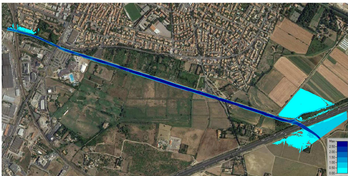
Figure 51 : Etat projeté, 80 m 3 /s (AVEC reprise du pont de la Liberté, avec déversoir en rive droite)
