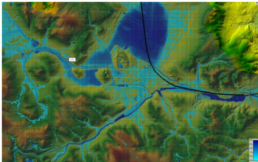
Figure 6 : Extrait du modèle hybride hydrologique/hydraulique utilisé dans le cadre de la précédente analyse de BRLi
